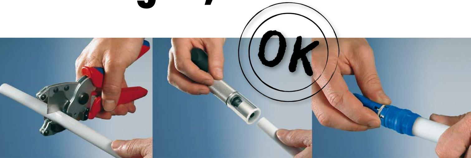
Die Haßfurter DW Verbundrohr GmbH bietet jetzt das neue Steckfittingsystem der Marke Multitubo Systems an. Wichtigstes Merkmal dieses Rohrleitungssystems ist sein Steckfiting. Dieser besteht aus einem Metallgrundkörper mit einem Gripring und einer Kunststoffhülle. Der patentierte Gripring soll das Rohr beim Einschieben
