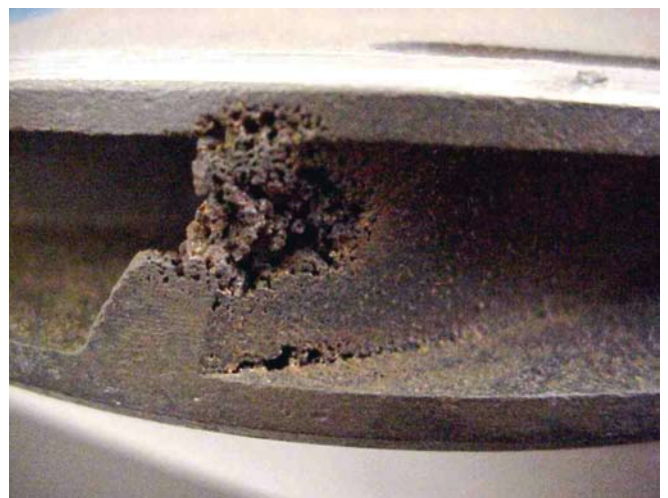
Sieht man genauer hin wird deutlich, welche enormen Kräfte bei einer Kavitation freigesetzt werden
