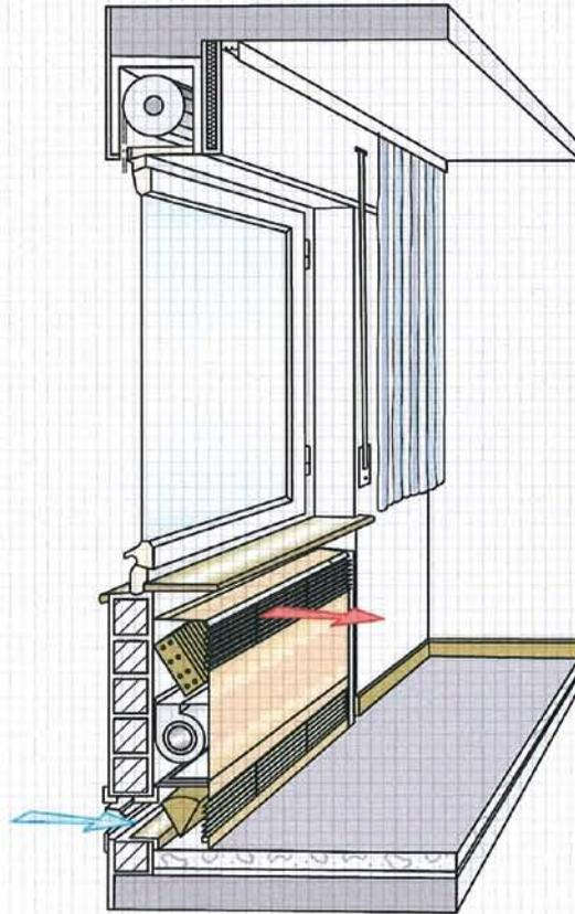
Ein Ventilatorkonvektor besteht aus dem Gehäuse mit den Einbauteilen
