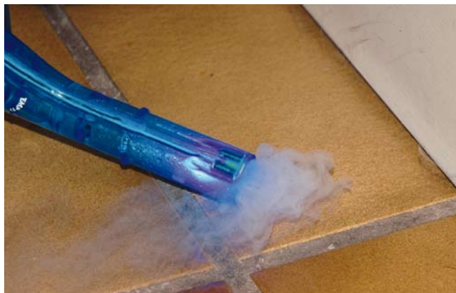
Testnebel macht einströmende Luft bei Unterdruck sichtbar
