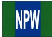
Die Kennzeichnung erfolgt mittels Farbe und Kürzel oder mit Farbe und Text: (v. l.) Trinkwasser kalt (Kürzel), Trinkwasser kalt (Text), Trinkwasser warm (Kürzel), Betriebswasser (Kürzel)
