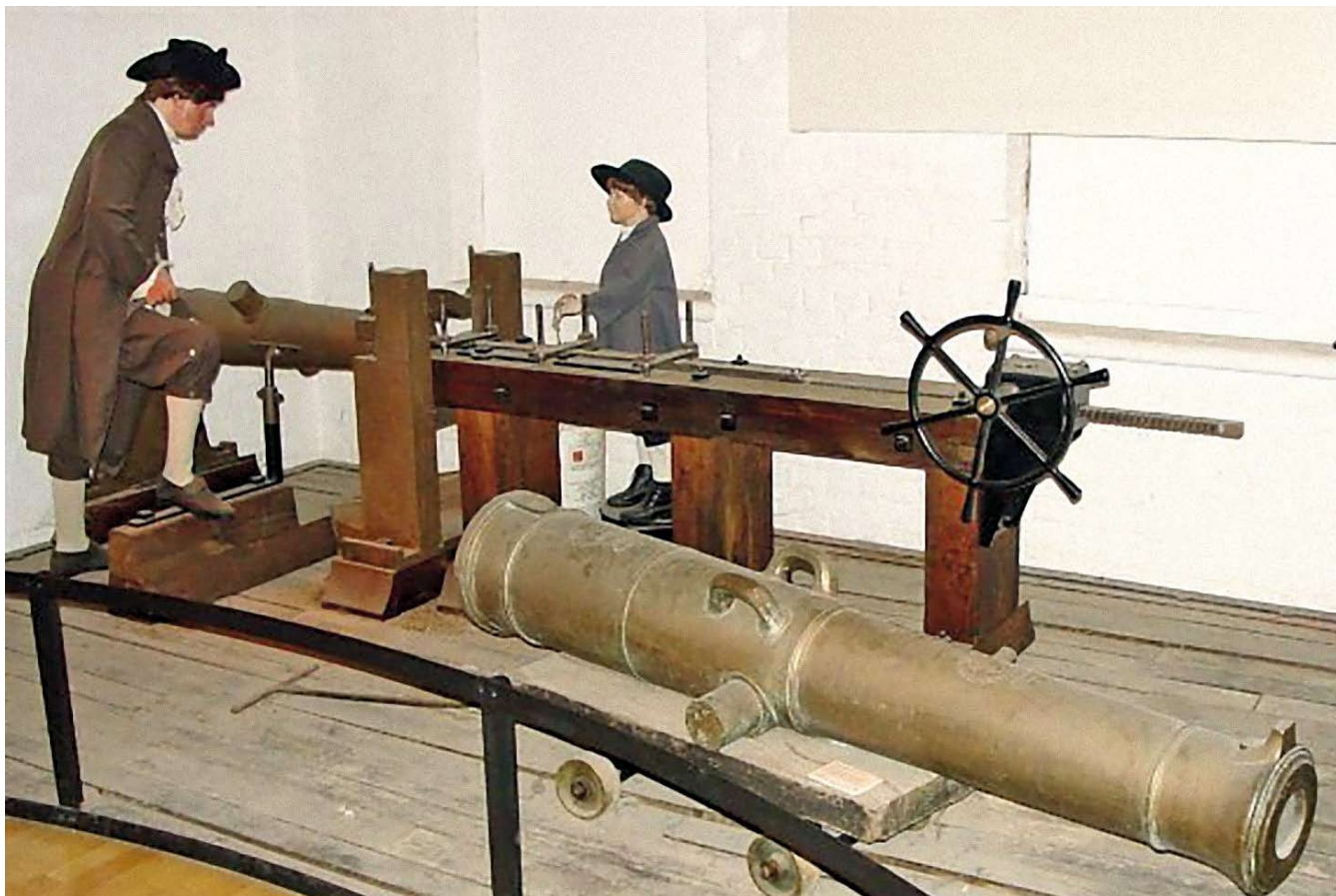
Beim Arbeiten an dieser Vorrichtung zum Bohren eines Kanonenlaufs hatte Benjamin Thompson seine neue Idee zur Wärme
