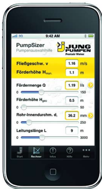
Mit dem iPod Pumpen auslegen: Dank Software von Jung kein Problem
