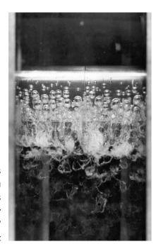
So ähnlich sieht es im Versuchsaufbau aus, kurz bevor das Wasser bei zehn Meter Saughöhe den "Halt" im Rohr verliert
