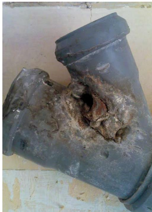
**Kein Witz: Hier hat jemand versucht, ein HT-Rohr mit der Flamme zu schweißen**
