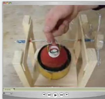
Schwer vorstellbar, dass so etwas funktioniert? Wer da Zweifel hat, kann sich einen Stirlingmotor selber mit einfachen Mitteln bauen. Wenn's heiß ist, kann mit einem Teelicht ein Ventilator betrieben werden. Wie das aussehen kann, wird hier gezeigt:
