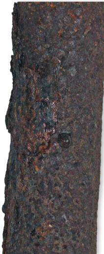
Dieses Rohrstück war Teil einer Stahlrohr-Gasleitung, die in einem feuchten Keller"schwarz" verlegt wurde
