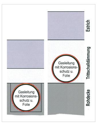
Gasleitungen im Fußbodenaufbau müssen wie erdverlegte Leitungen geschützt werden; bei Stahlleitungen ist zusätzlich die Umwickelung mit PE-Folie nötig
