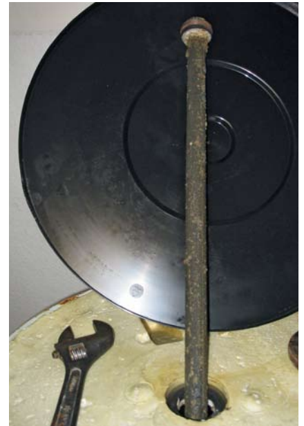
Eine Opferanode im ausgebauten Zustand, hier mit nur geringem Abtrag
