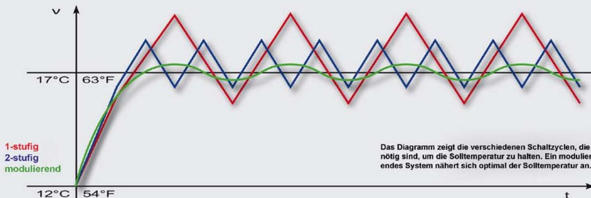
Das Diagramm zeigt die verschiedenen Schaltzyklen, die nötig sind, um die Solltemperatur zu halten. Ein modulierendes System nähert sich optimal der Solltemperatur an.
