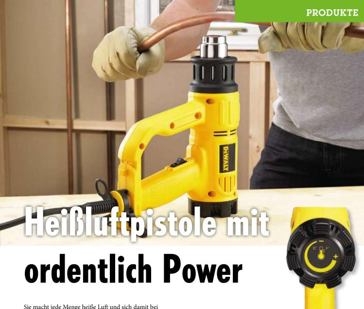
Sie macht jede Menge heiße Luft und sich damit bei einer Vielzahl von Anwendungen nützlich: die neue Heißluftpistole D 26411 von DeWalt. Dafür sorgt die Kombination aus dem 1800 Watt starken Gebläsemotor und einem Heizelement mit Keramikkern. Das Thermostat sowie ein zusätzlicher Thermofühler am vorderen Ende der Heizspirale verhindern deren Überhitzen und garantieren so eine hohe Lebensdauer auch bei längerem Einsatz.
