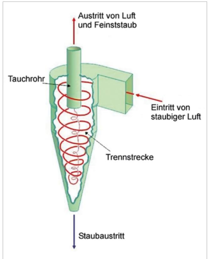
**Das Prinzip des Zyklonabscheiders ist recht simpel – die Fliehkraft macht's**
