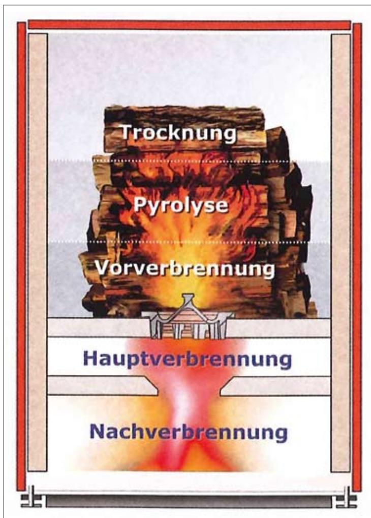
**Im Sturzbrand vollzieht sich der Verbrennungsprozess im Vergaserkessel buchstäblich von oben nach unten**
