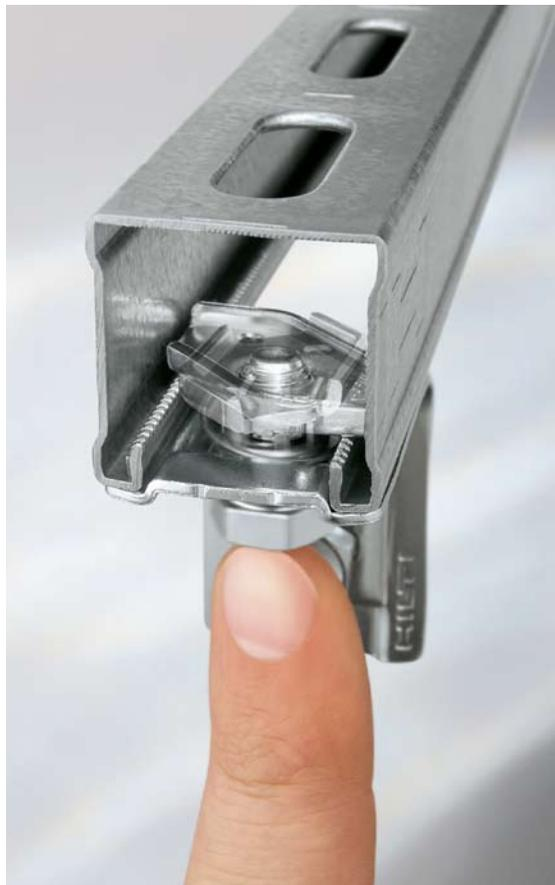
Mit dem neuen Montagesystem MM von Hilti lassen sich Rohre einfach befestigen. Über einen Klick-Mechanismus können Anbindungselemente für Schellen, Winkel oder Schienenfüße in die Schiene gedrückt werden. Die Gewindeplatte verriegelt sich im
