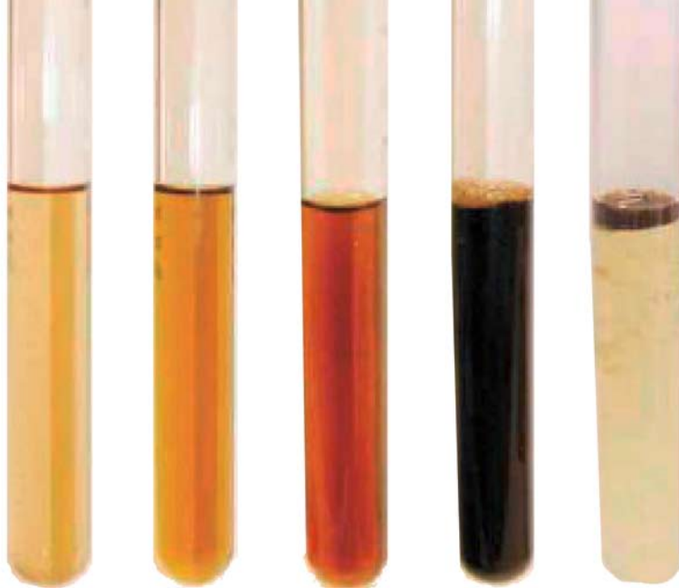
Sichtbare Alterungserscheinungen von Solarflüssigkeiten nach entsprechender Temperaturbelastung
