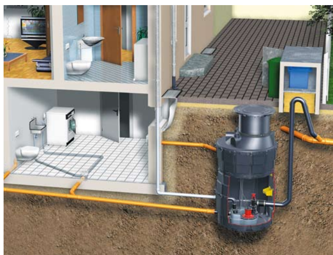
Um Platz im Haus zu sparen, kann die Anlage auch in einem Schacht außerhalb des Gebäudes installiert werden
