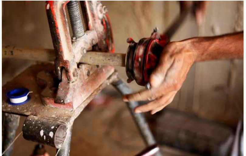
Mit der Handkluppe werden die Gewinde oft noch geschritten. Das spart auch das Fitnessstraining am Abend
