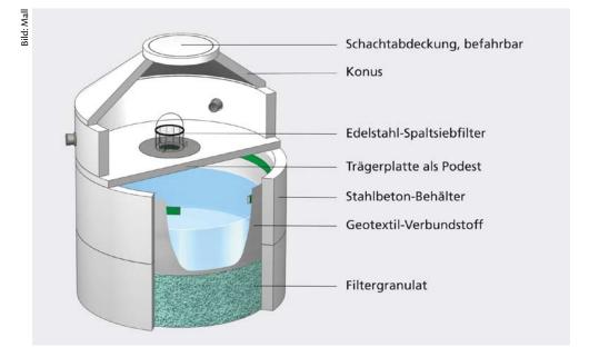
Der Metalldachfilter, hier Tecto Typ MVS, nimmt das Wasser zur Vorbereitung auf die Versickerung auf und hält bis zu 97 % der Schwermetalle zurück
