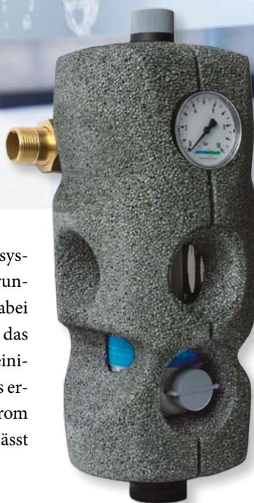
Mit dieser Kombination kann ein Trinkwassersystem vor hohen Drücken und gleichzeitig vor Verunreinigungen geschützt werden. Der Filter ist dabei rückspülbar. Das bedeutet, dass bei einer durch das Schauglas feststellbaren Verschmutzung eine Reinigung mittels des vorhandenen Wasseranschlusses erfolgen kann. Dazu lenkt sich dann der Wasserstrom gegen die sonstige Strömungsrichtung und entlässt das Wasser direkt nach unten aus dem Filter.
