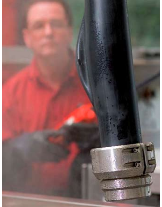
Das typische Bild beim Versagen eines Rohres, die Schwachstelle verläuft längs des Rohrverlaufs
