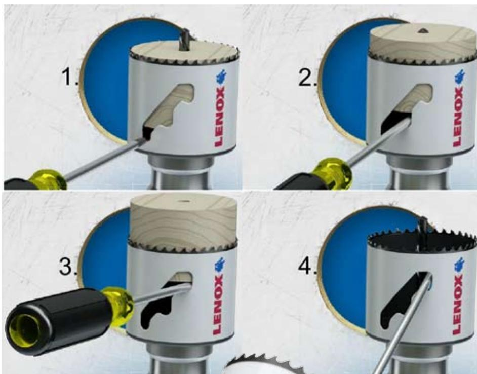
Mit dem Modell T2 von Lenox präsentiert der Hersteller einen echten Problemlöser für die Baustelle. Der ansonsten oft schwierig zu entfernende Bohrkern kann durch die stufenförmigen Aussparungen leicht mittels Schraubendreher herausgeholt werden. Dies bezeichnet der Hersteller als Speed-Slot-System. Die Verwendung von zwei Metallen im Aufbau der Lochsäge, also ein Bimetall, soll eine besonders lange Lebensdauer begünstigen. Die geringe Wanddicke sorgt für eine hohe Schnittleistung.
