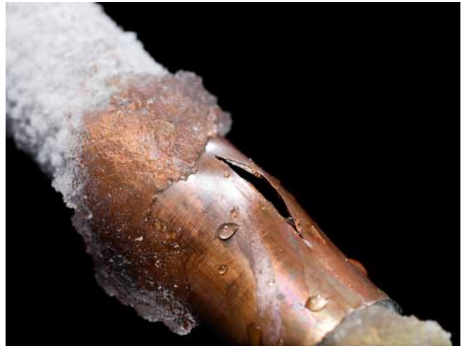
Ein Rohr-Platzer wie im Bilderbuch, parallel zur Längsachse
