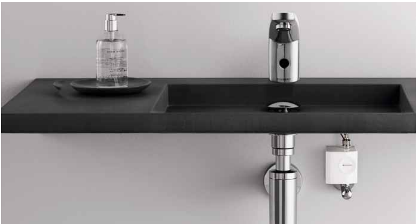
Der Generator in der Trinkwasserzuleitung macht berührungslose Waschtisch-Armaturen unabhängig von der Stromversorgung über das Stromnetz oder den Batteriebetrieb
