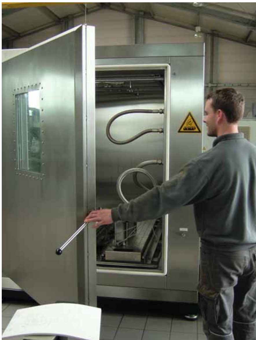
Prüfkammer für Fahrzeugteile, Beanspruchung auf Temperatur, Druck, mechanische Kräfte
