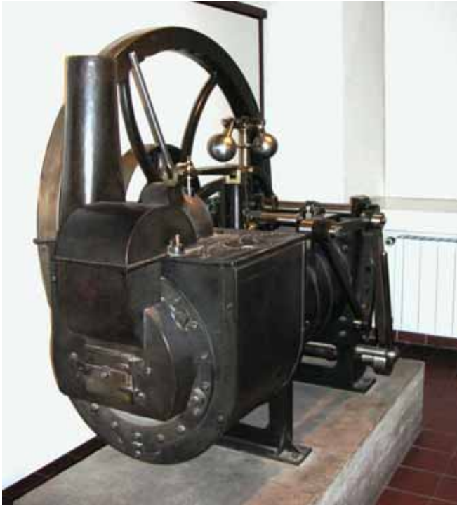
Stirling-Motoren lassen sich buchstäblich mit allen Brennstoffen betreiben. Das hat man schon in der Vergangenheit geschätzt
