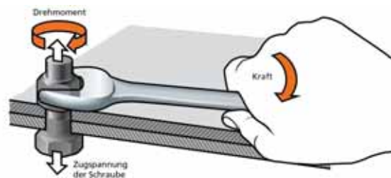
Um mittels Aufbringen eines Drehmoments zwei Teile zu verbinden, wird eigentlich die Zugspannung der Schraube genutzt
