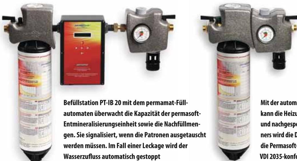
**Befüllstation PT-IB 20 mit dem permamat-Füllautomaten überwacht die Kapazität der permasoft-Entmineralisierungseinheit sowie die Nachfüllmengen. Sie signalisiert, wenn die Patronen ausgetauscht werden müssen. Im Fall einer Leckage wird der Wasserzufluss automatisch gestoppt**
