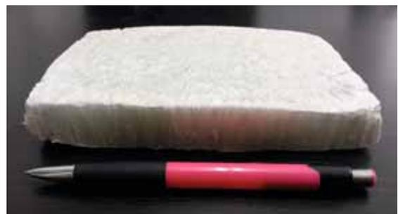
**Produktmuster: Dämmplatte aus nanokristalliner Cellulose (NCC)**
