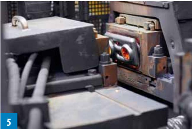
5 Im nächsten Schritt werden jeweils zwei Halbschichten zu einem Doppelkopfstück zusammengeschweißt
