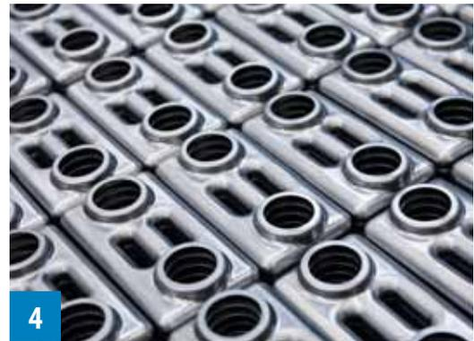
Die Coils mit dem Bandstahl werden durch eine Presse geführt und zu Halbschichten gestanzt
