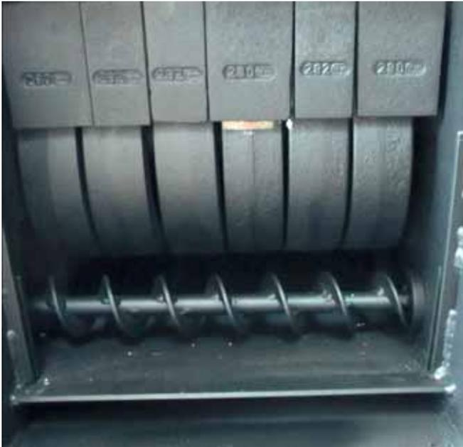
**Herzstück der Anlagen ist ein patentierter Rollrost, der Verunreinigungen im Brennstoff stetig abführt und gleichzeitig Luft in den Glutstock lässt, um die Verbrennung zu verbessern**
