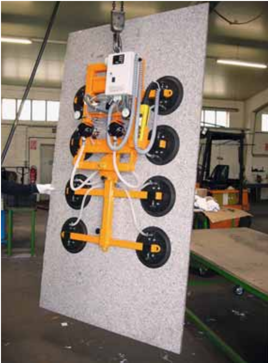
Auch sehr schwere Gegenstände lassen sich mittels Vakuumtechnik anheben und einfach transportieren
