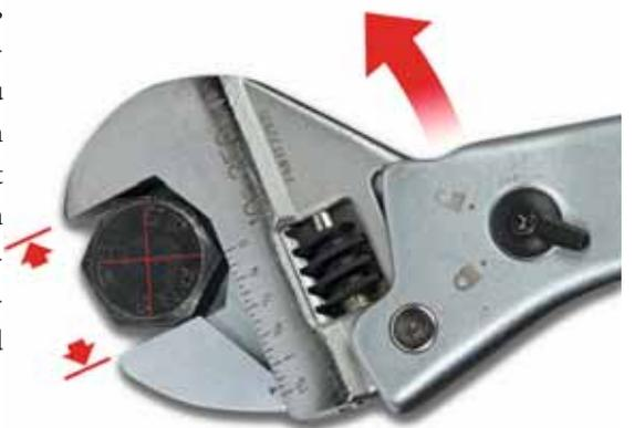
**Dreht man gegen den Uhrzeigersinn, ist der Kopf des Schlüssels beweglich, die Backen öffnen sich und rutschen über die Mutter. So kann man neu ansetzen ohne Absetzen**
