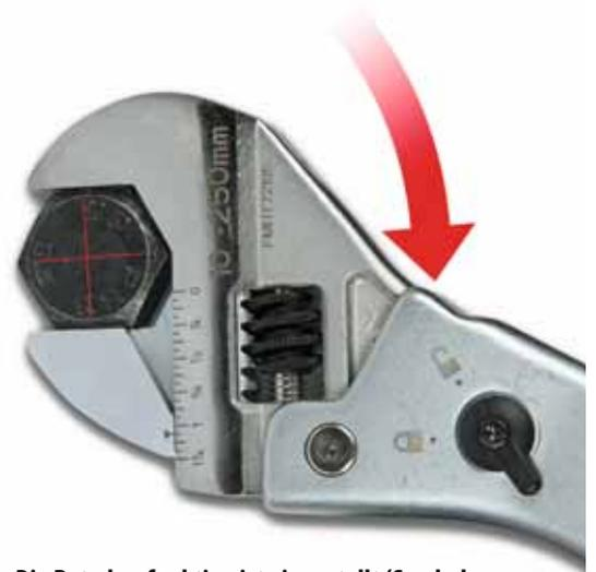
**Die Ratschenfunktion ist eingestellt (Symbol geöffnetes Schloss). Dreht man den Schlüssel im Uhrzeigersinn, ist der Kopf des Schlüssels blockiert, die Backen umfassen fest die Mutter und ziehen sie an**
