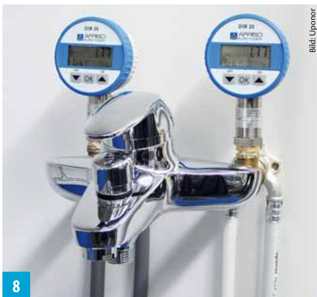
Prüfstandmessung: Die Zapfmengen über die Badewannen-Armatur wurden gemessen
