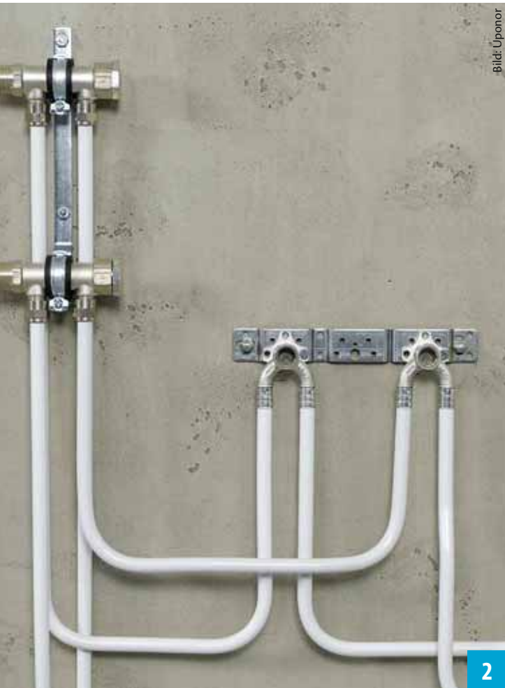
Doppel-Wandscheiben ermöglichen in Reihen- und Ringinstallationen das Durchschleifen der Trinkwasserleitung ohne Stagnationsstrecke
