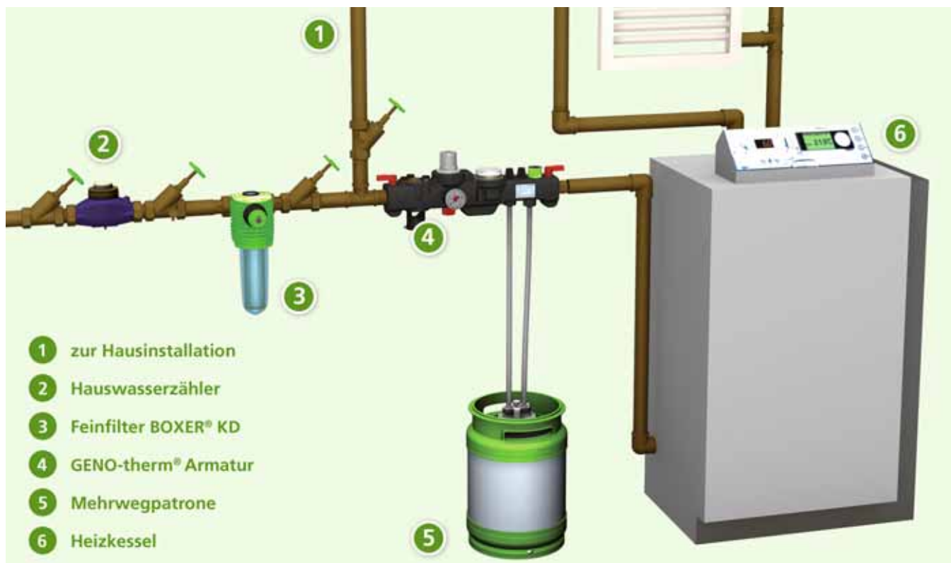
Einbindung der GENO-therm Armatur zwischen Trinkwasserinstallation und Heizungssystem
