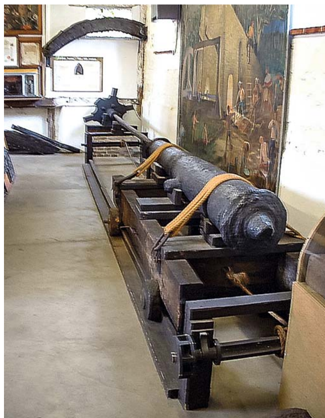
Beim Arbeiten an einer solchen Vorrichtung zum Bohren eines Kanonenlaufs hatte Benjamin Thompson seine neue Wärmetheorie erdacht
