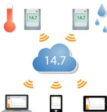
Für den Start der Feuchte- und Temperaturüberwachung mit testo Saveris 2 ist das Vorhandensein eines lokalen Funknetzwerks (WLAN) Voraussetzung. Das lokale Netzwerk wird von einem Router aufgebaut. Lokales WLAN und Internetzugang sind für den Betrieb von Testo Saveris 2 zwingend notwendig.
