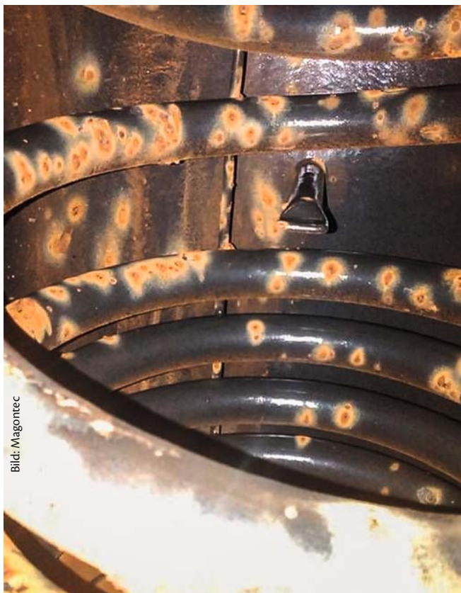
Ungeschützter, ständiger Kontakt mit frischem Trinkwasser kann zumindest bei einfachem Stahl zu Rost führen
