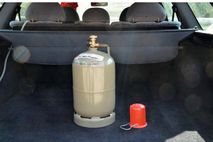
Ein No-Go! Der Transport ohne Schutzkappe und ohne Befestigung auf der Ladefläche im Fahrzeug. Das kann schon während einer kurzen Fahrt zum Verhängnis werden
