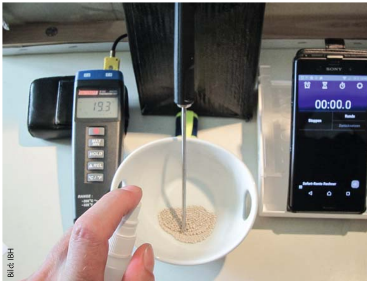
Zu Beginn des Versuchs betrug die Temperatur der trockenen Körner und des Wassers 19,3°C
