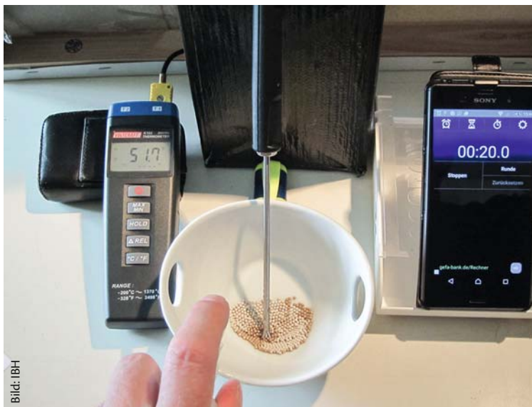
Nur durch das Besprühen mit Wasser stieg die Temperatur rund um die Körner auf 51,7°C
