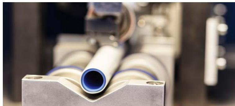
Kunststoffrohren und punkten dabei vor allem durch ihre leichte Biegsamkeit bei gleichzeitig hoher Formstabilität. Sie haben ein geringes Gewicht und eignen sich wegen der hohen Druck-, Temperatur- und Korrosionsbeständigkeit für unterschiedliche Anwendungen.
