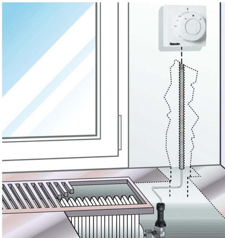
Unterflurkonvektoren lassen sich ebenfalls am besten per Ferneinstellung regeln
