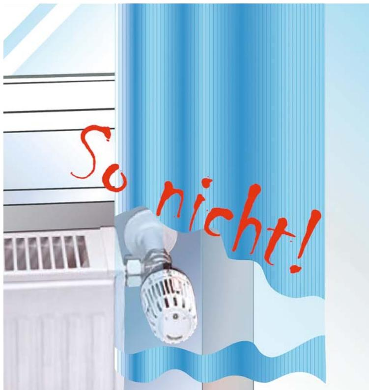
Der Thermostatkopf mit eingebautem Fühler darf nicht von Vorhängen verdeckt werden
