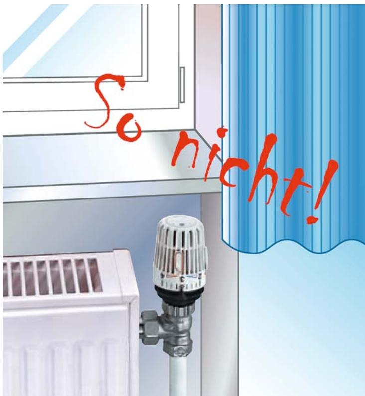
**Der Thermostatkopf mit eingebautem Fühler darf nicht senkrecht montiert werden**
