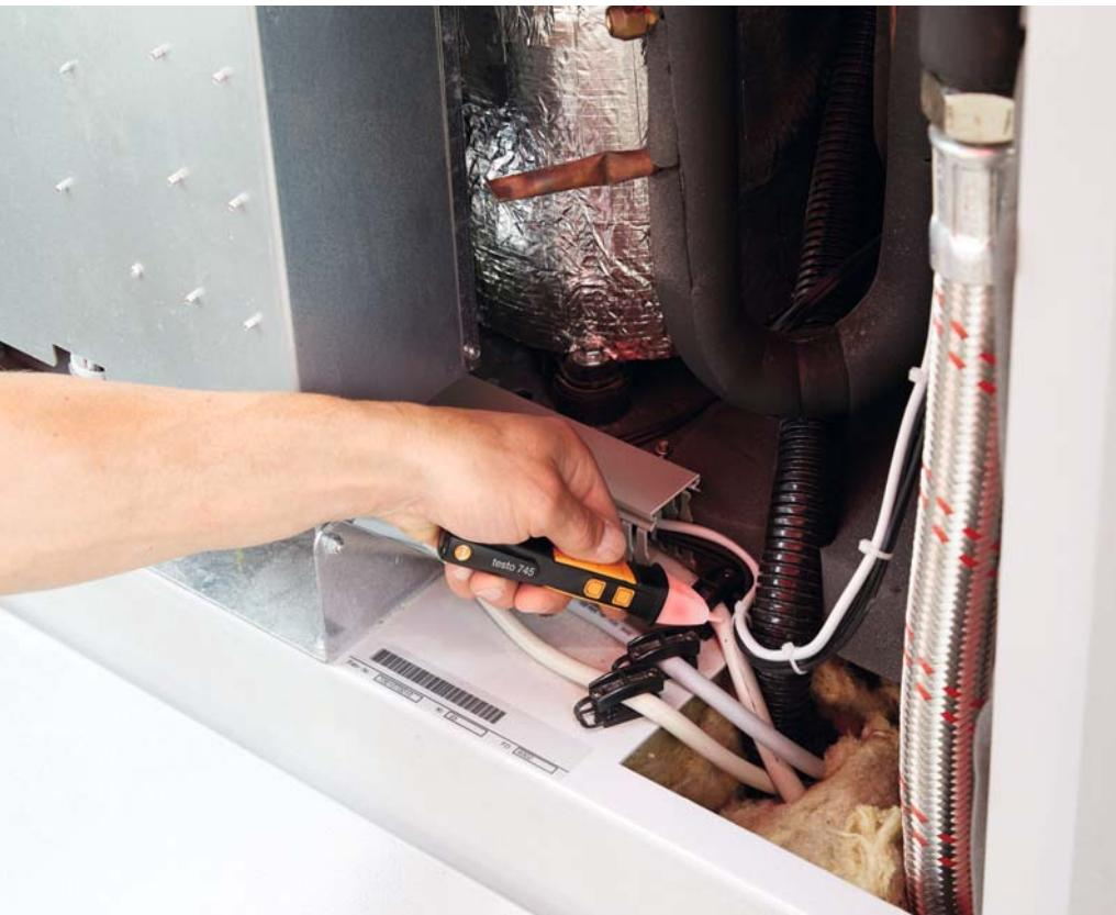
Sie kommen auf eine Baustelle und sind sich nicht sicher, ob eventuell noch Spannung auf den Leitungen eine Gefahr darstellt. Mit einem Phasenprüfer ist man zwar irgendwie auch messtechnisch unterwegs, aber schneller, zuverlässiger und vor allem sicherer ist man mit einem kontaktlosen Span-
