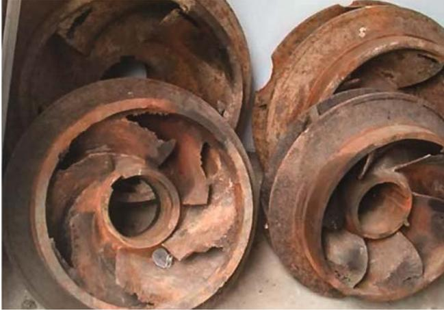
**Durch Kavitation geschädigte Pumpenlaufräder**
