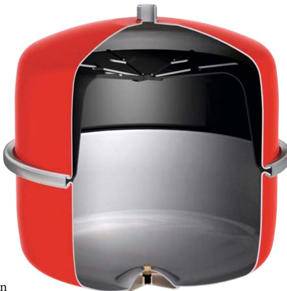
**Auch ein Ausdehnungsgefäß ist auch nur eine Luftblase im System. Allerdings schirmt eine Membrane das Gas vom Heizungswasser ab**
