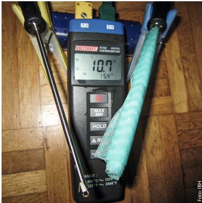
Zwei Temperatursensoren in einem Luftstrom mit Anzeige der jeweils gemessenen Temperatur
