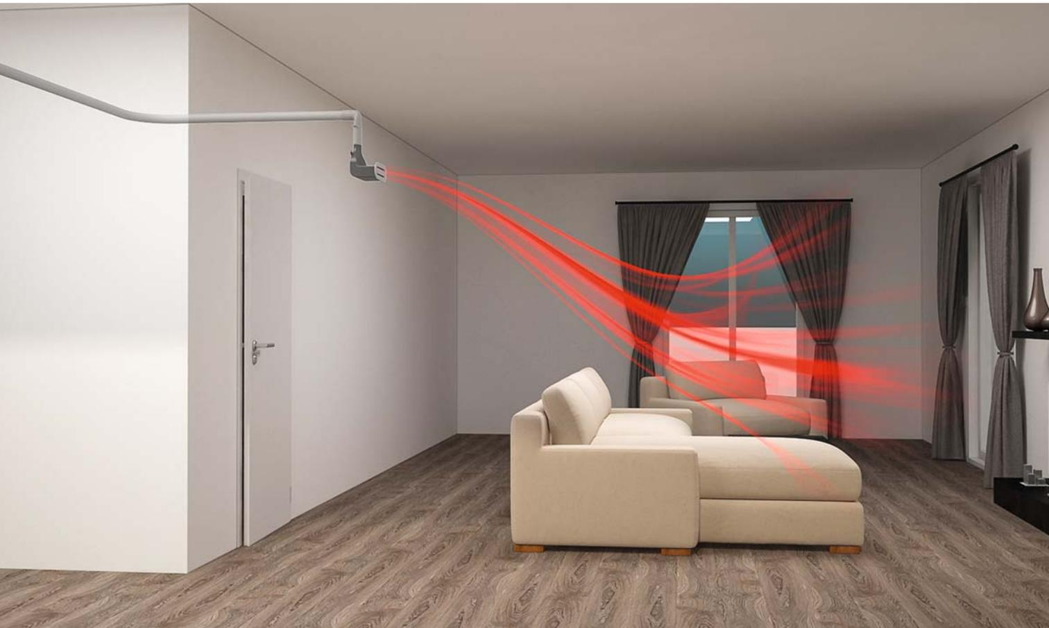
**Kontrollierte Wohnraumlüftung leitet über ein Rohrsystem in der Wand oder im Boden frische, gefilterte Außenluft ins Gebäude und transportiert gleichzeitig verbrauchte Luft ab**
