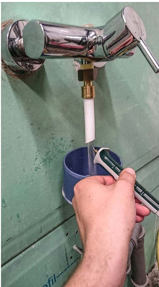
Bild 2: Die Versuche starten mit der Simulation eines 6-minütigen Duschvorgangs, bei dem die Wassertemperatur über den Handmischer auf 40 °C eingestellt wird.
